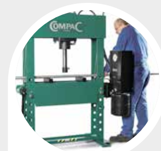
Pumpen kan svängas i 90 graders vinkel från pressen.
