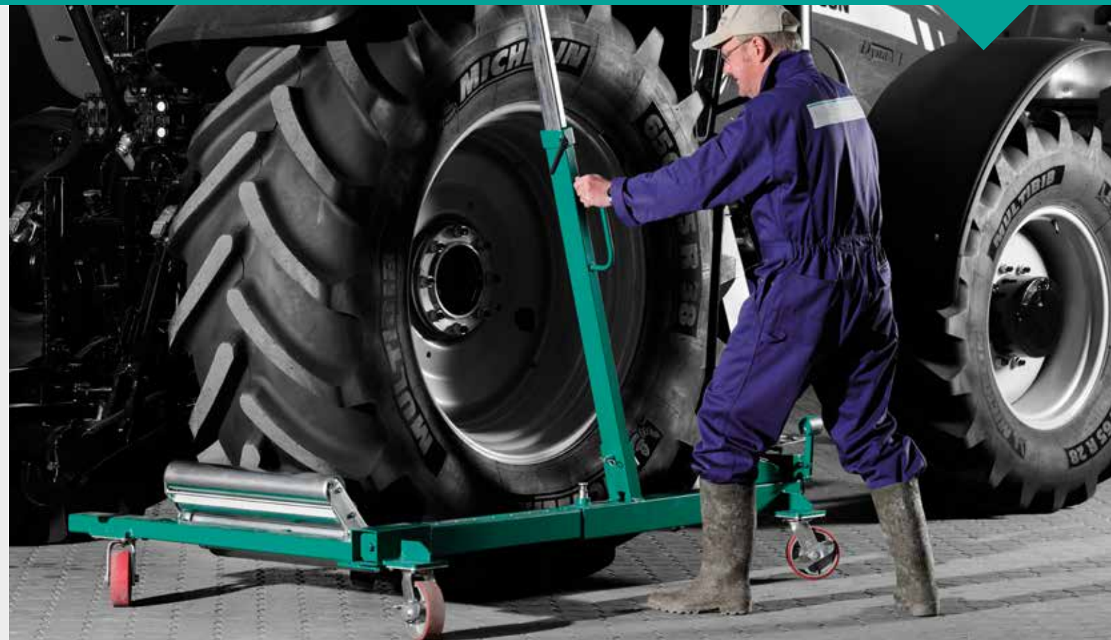
Klarar hantering av stora hjul från 1250 mm upp till 2400 mm i diameter och upp till 1050 mm djup.
